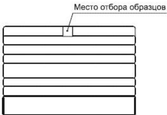
Рисунок 6 - Схема выполнения семислойной наплавки лентой (допускается отбор двух параллельно расположенных образцов)
